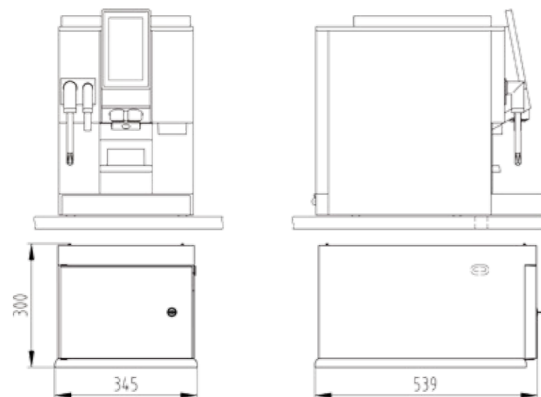
Unterstellkühlleinheit unter Kaffeemaschine
